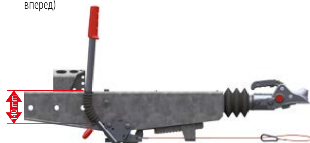
Рычаг ручного тормоза затянут (стояночный тормоз при движении задним ходом, тормоз настроен оптимально)
