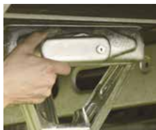
Установите противоугонное устройство в пазы и сдвиньте его вправо
