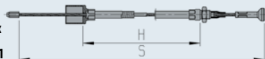
Быстрая установка на быст- ромонтируемый уравниватель тормозных тросов для колесных тормозов 1636G, 1637, 2051, 2361
