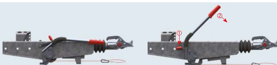
Рычаг ручного тормоза затянут = тормозная тяга натянута
