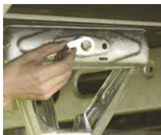
Наденьте стопор на головку винта вращения опоры
