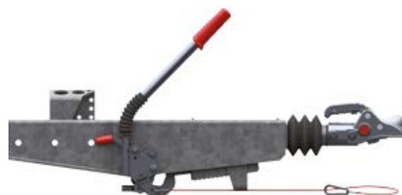
Рычаг ручного тормоза затянут (стояночный тормоз при движении вперед)
