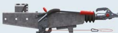
Рычаг стояночного тормоза затянут = тормозная тяга натянута, рычаг ручного тормоза опущен
