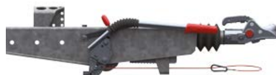
Рычаг ручного тормоза опущен (режим движения)
