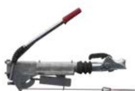
Рычаг ручного тормоза затянут (стояночный тормоз при движении вперед)
