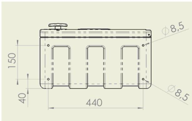
In Staubox vier Montagebohrungen Ø8,5 bohren.
