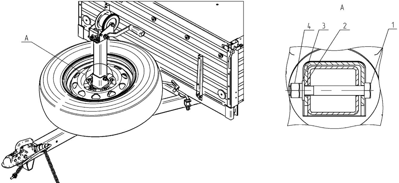
Рис. 1 - Установка комплекта. . 1 - Болт М12х90; 2 - Шайба 12 65Г 0115 ГОСТ 6402-70; 3 - Шайба С.12.01.0115 ГОСТ 11371-78; 4 - Гайка М12.
